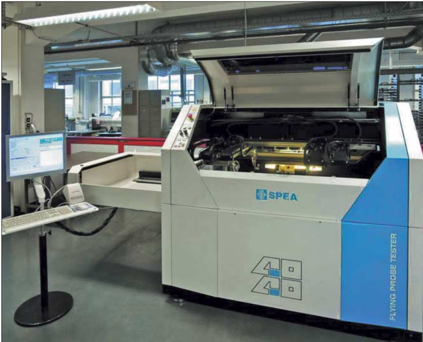
Bild 3: Der Flying Probe-Tester Spea 4040 – eine hochflexible Test-Lösung gerade für die Produktvielfalt von Prototypen
